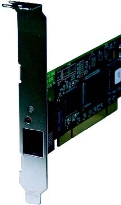
Bei der TE110P (E100P,T100P) handelt es sich um eine 1-Port T1/E1 Karte. Auf der Karte befindet sich ein Jumper, der angibt ob die Karte im T1 oder im E1 Modus arbeiten soll. Setzen Sie diesen Jumper Ihres Wunsches entsprechend. Diese Jumper gibt es bei den obsoleten E100P und T100P Karten nicht, weil hier für jede Art eine eigene Karte existierte. Bauen Sie die Karte in einen freien PCI-Steckplatz ein und Fahren Sie das System hoch.
