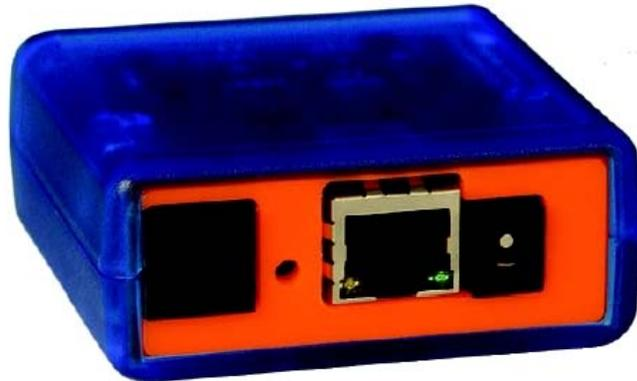
Beim IAXy handelt es sich um einen s.g. VoIP-ATA (Voice over IP Analog Telephone Adaptor). D.h., mit diesem Gerät kann man ein handelsübliches Analogtelefon in ein IP-Telefon verwandeln.
