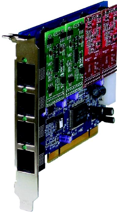
Bei der TDM400P handelt es sich um das Trägerboard für insgesamt vier analoge Module. Folgende Kombinationen werden vorgefertigt angeboten:
