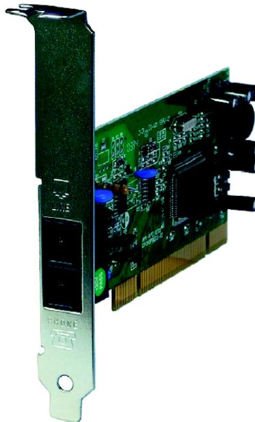
Bei der X100P handelt es sich um eine 1-Port FXO Karte, die es ermöglicht einen analogen Telefonanschluss in das Asterisk System zu führen. Nach dem Einbau der Karte fügen Sie folgendes in Ihre „zaptel.conf“ ein:
